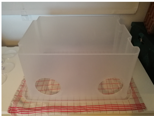
Tämän laatikon reiät on tehty 100 mm reikäsaahalla.
