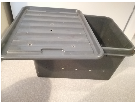
Laatikon kaikkiin sivuihin on porattu 10 mm reikiä noin 10 cm välein, myös kansi on rei'itetty raittiin ilman sisäänvirtauksen mahdollistamiseksi. Läpinäkyvä kansi olisi parempi.
