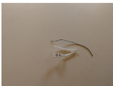
2. Irrotetaan veitsen avulla pussinsulkijasta rautalanka.
